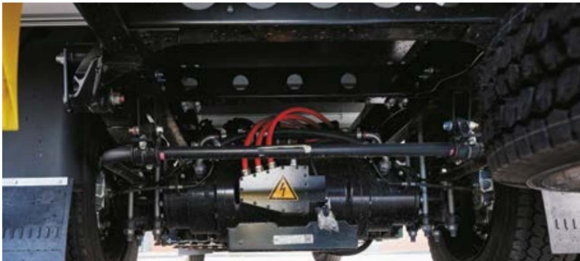
Eine Besonderheit des neuen E-Lkw ist die Platzierung der Antriebstechnik in der Hinterachse.
